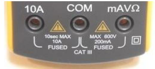
Para medir la resistencia, hay que conectar un cable al conector **COM** (negativo) y el otro al conector **mA/V/Ω** que es el conector positivo.
