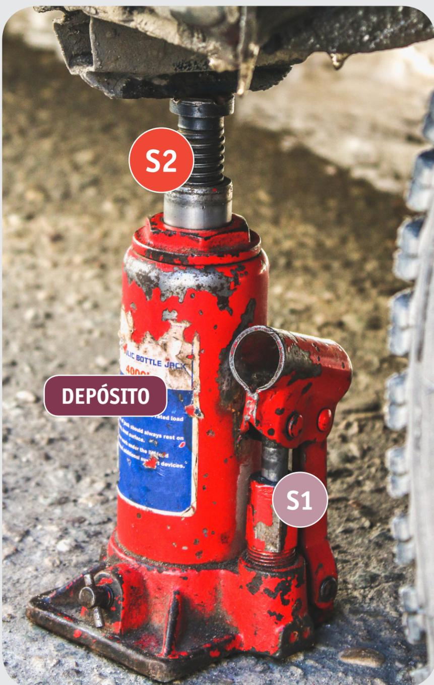
Una gata se compone de dos pistones **S1** y **S2**, **S1** de menor tamaño que **S2** ( $S1 < S2$ ), con sus correspondientes cilindros.
