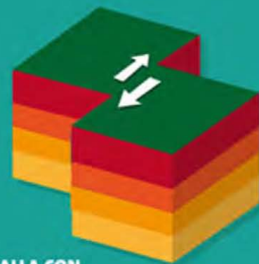
FALLA CON DESPLAZAMIENTO HORIZONTAL
