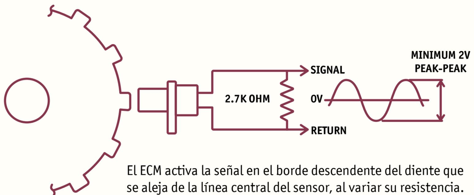
El ECM activa la señal en el borde descendente del diente que se aleja de la línea central del sensor, al variar su resistencia.
