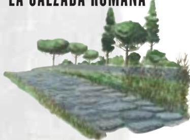
Estaba un poco combada para que el agua no se quedara en la superficie. Según Vitruvio, la calzada tenía que constar de
