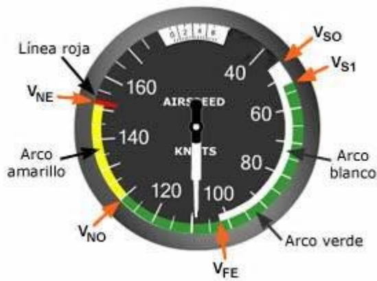
Típico anemómetro de aviación general con sus velocidades de referencia ( V_{mo}=V_{no} )
