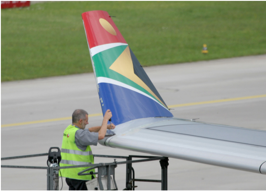
Aquí se aprecia el tamaño del gigantesco winglet de un Boeing 747-400 de South African Airways. El Winglet, aparte de añadir autonomía de vuelo al avión también sirve de elemento estético ostentando el logotipo de la compañía.
