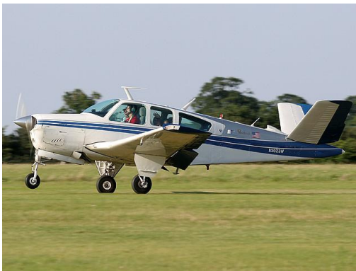
La Beech V35B Bonanza monta este peculiar diseño de cola, a pesar de ser una avioneta de escuela o deportiva.
