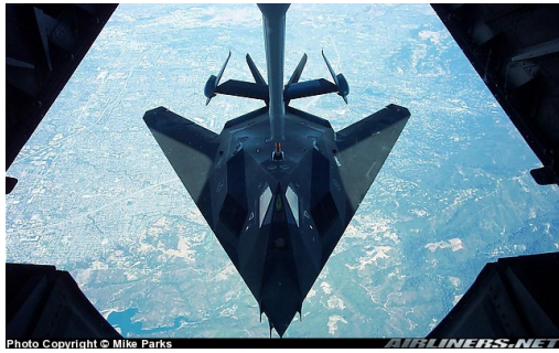
El F-117 es un claro ejemplo de ala con gran flecha. El F-1 Mirage III C a la derecha tiene ala en delta. La mayoría de aviones comerciales tienen ala en flecha.
