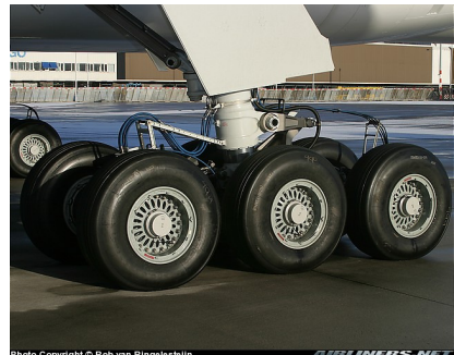
El tren de la piper 28 cherokee nada tiene que ver con el complejo tren principal de seis ruedas del boeing 777. Este tren debe soportar unas 203000 libras de peso y hacer rodar a un gigante
