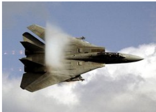
El F-14 Tomcat puede adoptar una diferente configuración alar según sus necesidades gracias a su ala de geometría variable.
