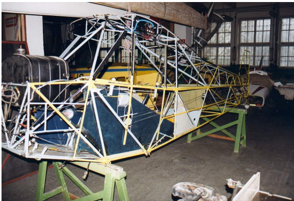
La Piper Cub es un claro ejemplo de fuselaje reticular o tubular.
