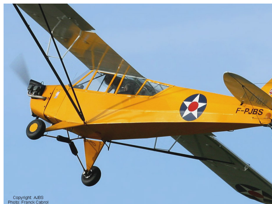
La Piper Cub es un claro ejemplo de fuselaje reticular o tubular.
