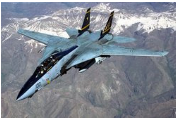
El F-14 Tomcat puede adoptar una diferente configuración alar según sus necesidades gracias a su ala de geometría variable.
