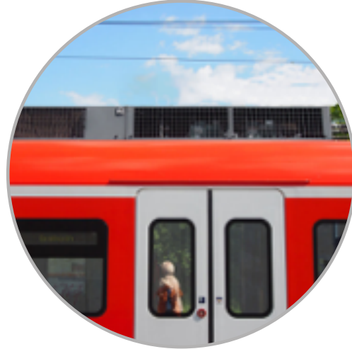
Figura 4: Aire acondicionado en el techo de un tren.
