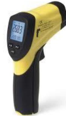
Éste se caracteriza por medir altas temperaturas y realiza la medición sin tomar contacto con la sustancia. Suele medir temperaturas que superan los 500 grados Celsius.
