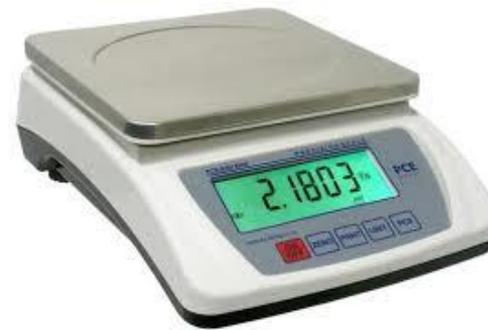
R: El instrumento A es un dinamómetro y mide peso, el instrumento B es una balanza eléctrica y mide masa.
