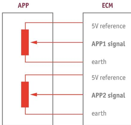
3. ¿Con cuánto voltaje se alimentan los sensores de posición del pedal de acelerador?
