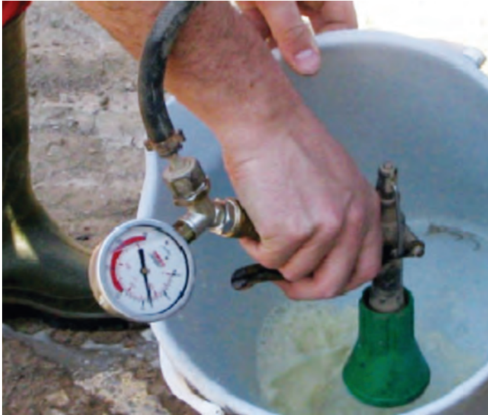
Figura 3.20. Evaluación de la pérdida de presión al final de la manguera.
