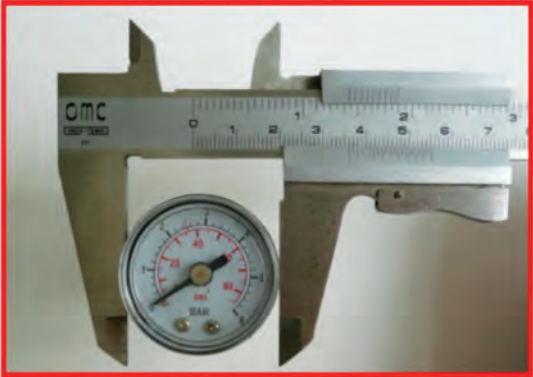
Figura 3.17. Manómetro incorrecto no alcanza más de 63 mm de diámetro.
