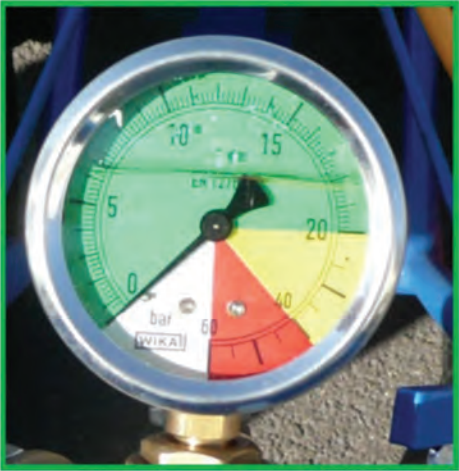
Figura 3.16. Manómetro del tamaño correcto, fácil de leer la presión de trabajo.
