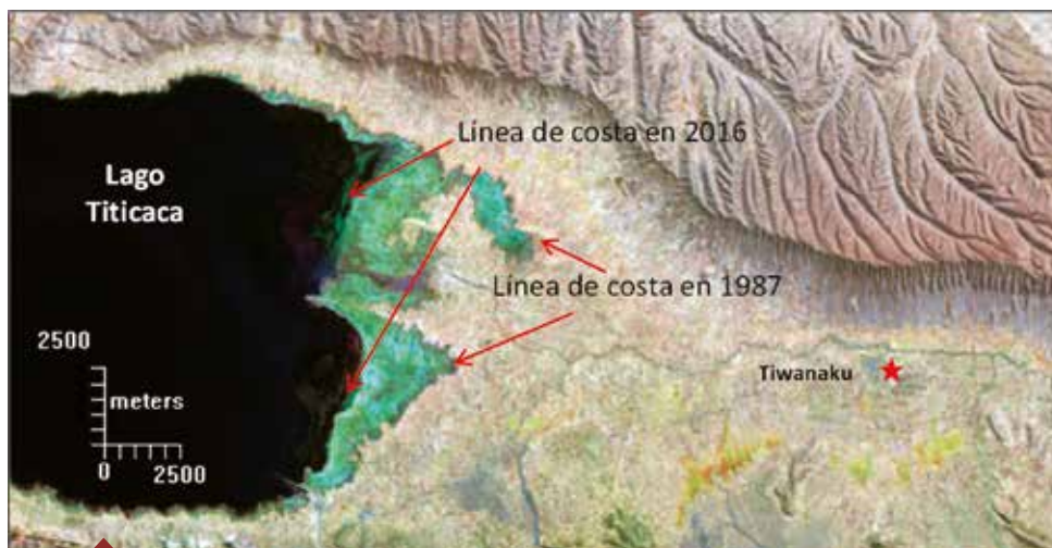
Ilustración 76. Solapamiento de imágenes Landsat 5 (18-07-1987) y Sentinel 2 A (02-08-2016) para detectar las variaciones de la línea de costa del borde suroriental del lago Titicaca (Lago Menor).
