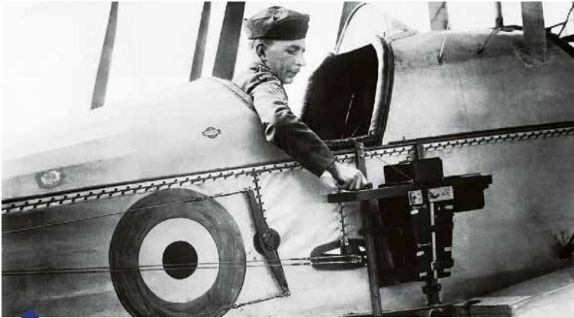
Ilustración 6. Avión de los Royal Flying Corps (Reino Unido), equipado con una cámara fotográfica. Primera Guerra Mundial. Fotografía Q33850: The Imperial War Museum.
