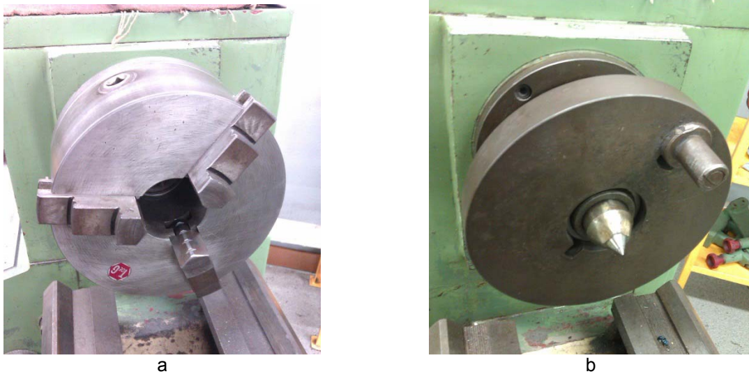
Figura 5. Plato de sujeción en el torno. (a) Plato de garras y (b) plato de arrastre.
