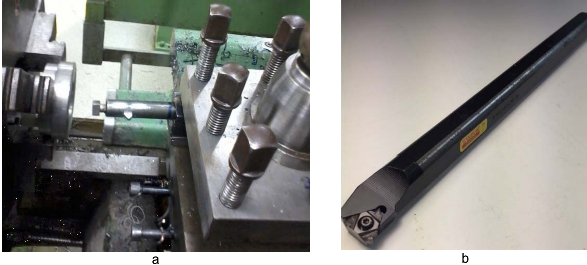
Figura 44. (a) Herramienta para el roscado interior empleada en las prácticas. (b) Herramienta con plaquita moderna para el roscado interior.
