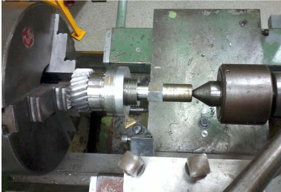
Figura 49. Cilindrado exterior de la tuerca.
