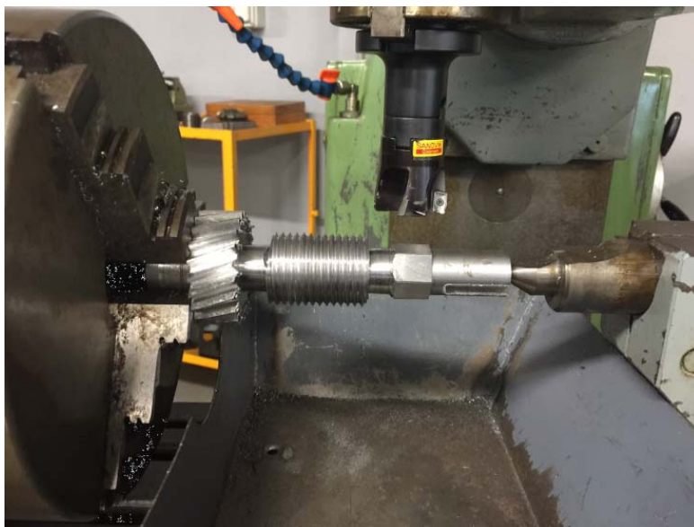
Figura 36. Sujeción de la pieza con plato de garras para el mecanizado del hexágono en la fresadora.
