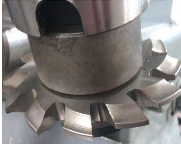
Figura 28. Fresa módulo 2, número 4 empleada en las prácticas.
