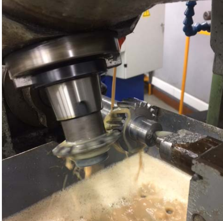
Figura 35. Mecanizado del piñón helicoidal.
