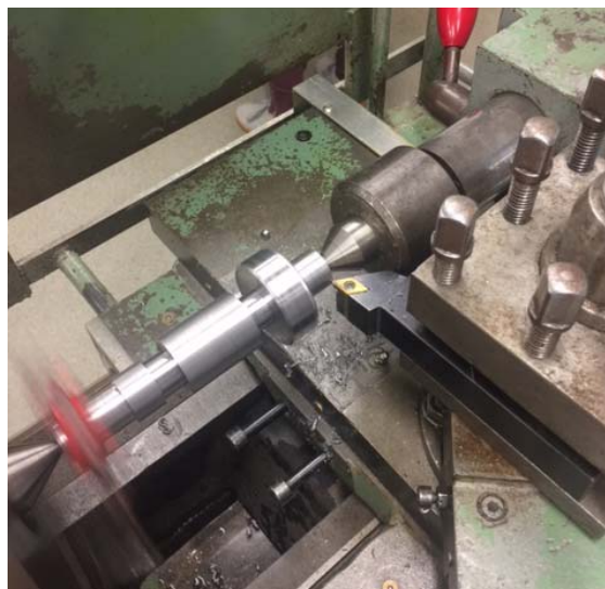
Figura 57. Mecanizado del chaflán CH3.
