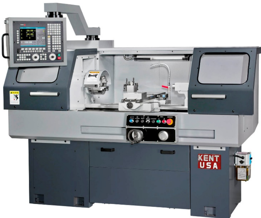
Figura 58. Torno CNC de dos ejes de la casa Kent USA (CSM-1440CNC). Foto cedida por Kentusa (Kent, USA, 2017).
