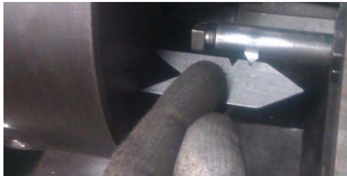
Figura 45. Posicionamiento de la herramienta de roscado interior perpendicular a la superficie a mecanizar.
