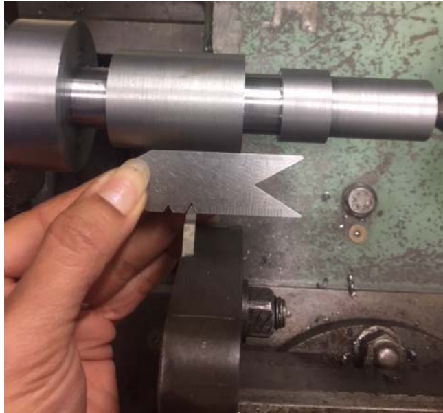
Figura 22. Posicionamiento de la herramienta de roscado exterior con ayuda de la plantilla de 60°.
