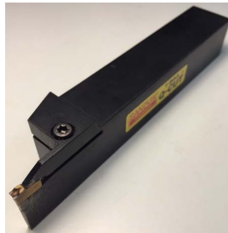
Figura 15. (a) Herramienta de ranurar empleada en las prácticas. (b) Herramienta y plaquita moderna de ranurado.
