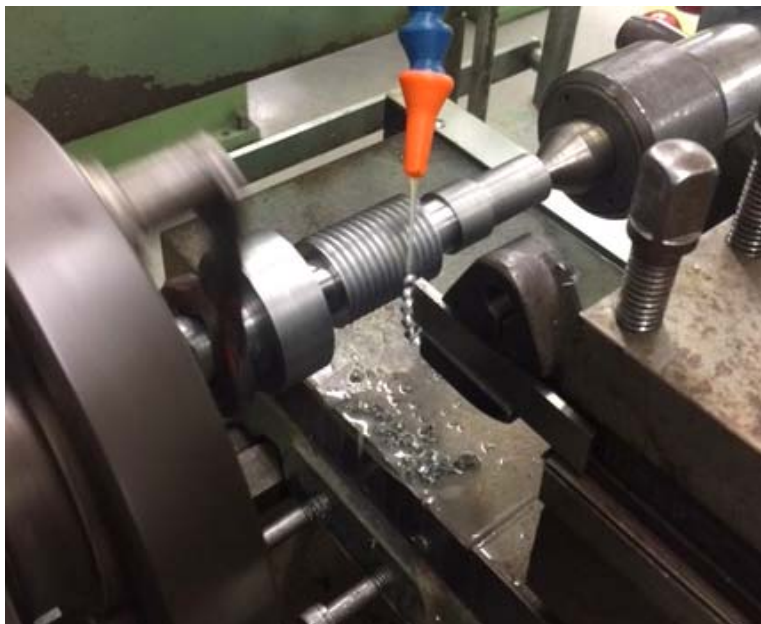
Figura 26. Mecanizado de la rosca exterior.
