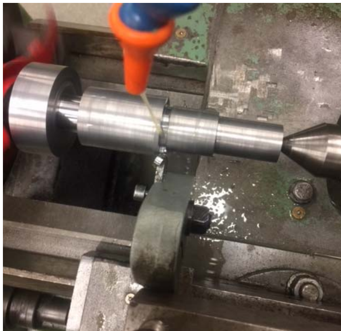
Figura 19. Ranurado de la segunda ranura de la pieza.
