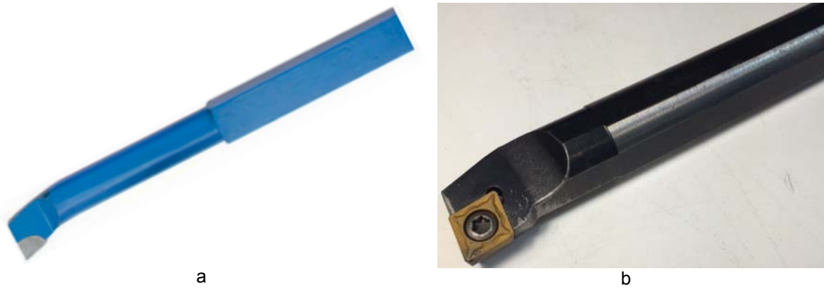
Figura 42. (a) Herramienta de cilindrado interior empleada en las prácticas. (b) Herramienta y plaquita moderna de cilindrado interior.
