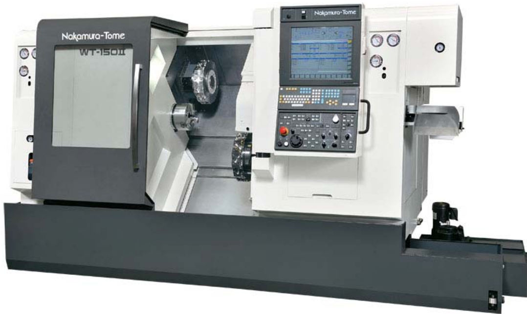
Figura 59. Centro de mecanizado multi-tarea de la casa Nakamura-Tome (WT-150II). Foto cedida por Nakamura-Tome (Nakamura-Tome, 2017).
