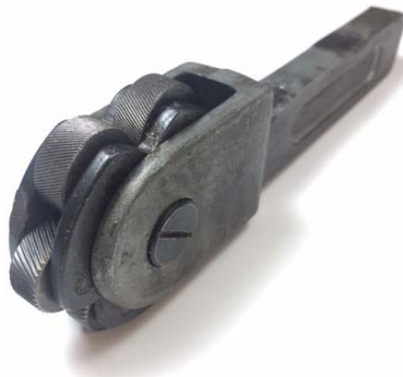
Figura 50. Moleta (herramienta para realizar moletados).
