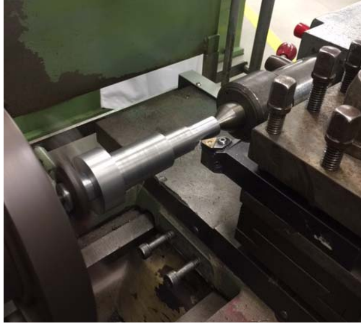
Figura 13. Cilindrado del último diámetro de la pieza (diámetro de 20 mm y 32 mm de longitud).
