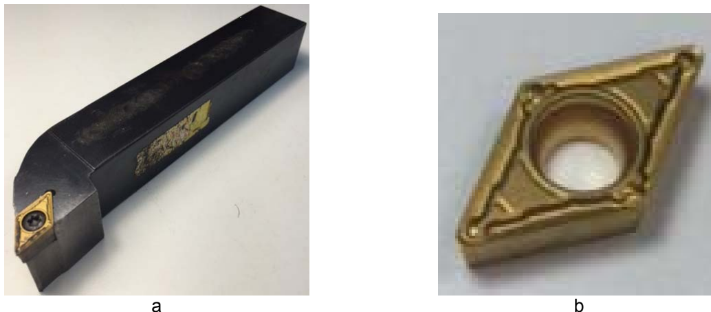
Figura 4. (a) Herramienta para cilindrar (plaqueta en su porta-herramientas). (b) Plaqueta.
