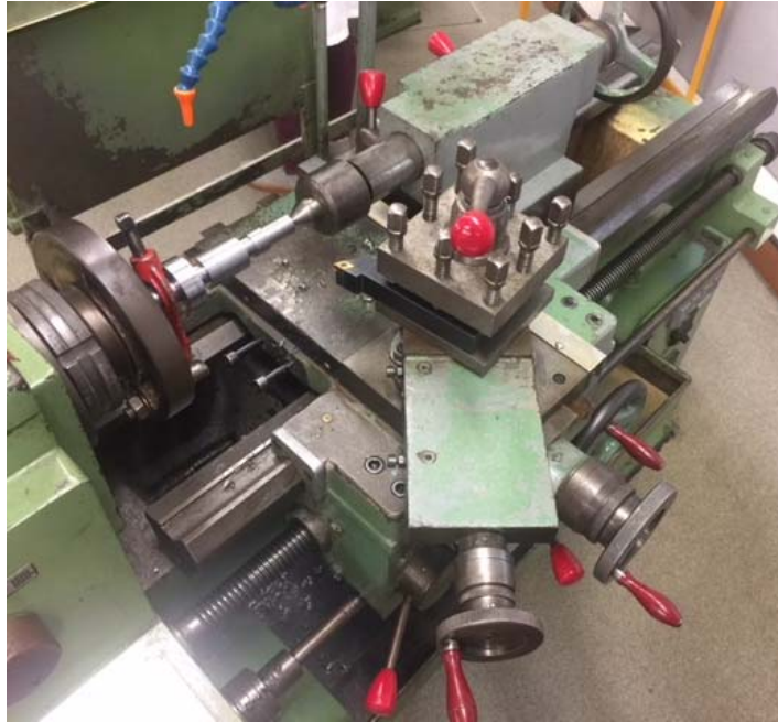
Figura 56. Posicionamiento del utillaje y herramienta para mecanizar los chaflanes.
