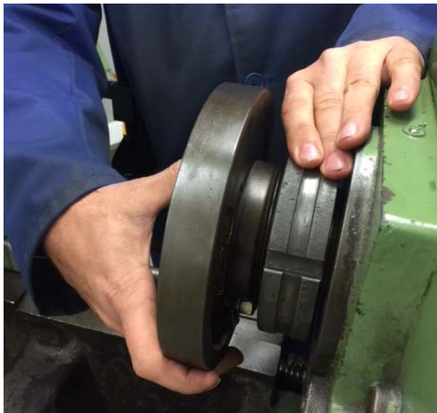
Figura 8. Giro manual de la tuerca que sujeta el plato.
