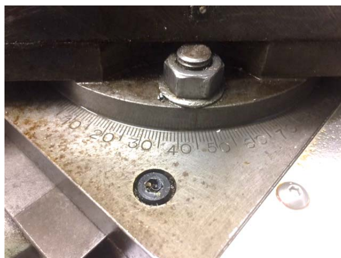
Figura 55. Giro de la parte superior del carro a 45^\circ .
