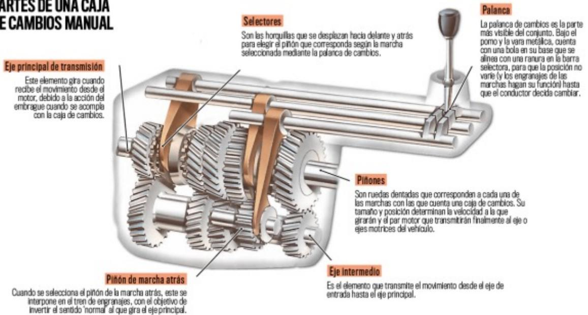
El **dispositivo sincronizador** es el que realmente acciona el conductor, a través de una barra selectora con una horquilla que mueve el sincronizador para engranar la marcha.
