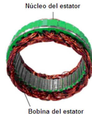
El sentido en que está enrollada la bobina crea polos magnéticos alternativos, norte y sur, cuando la bobina está proporcionando electricidad al exterior. Estos polos magnéticos serán mayores mientras mayor sea la intensidad proporcionada por el alternador.
