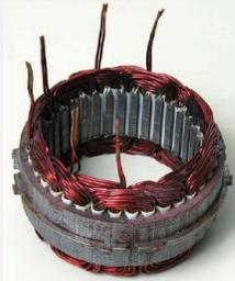
Se utilizan dos maneras de conectar los extremos de las bobinas inducidas entre sí: la conexión en estrella y la conexión en triángulo, que se diferencian por su corriente y tensión en obtenida en bornes.
