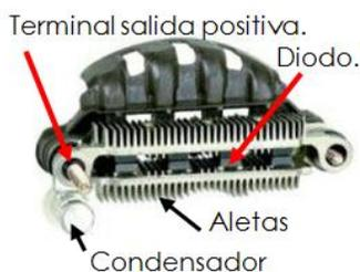
Otro aspecto a considerar es la temperatura admisible de trabajo de los diodos, la cual está limitado y, por ello, debe evacuarse el calor de las zonas donde se alojan, tanto los de potencia como los de excitación. Con este fin se montan sobre cuerpos de refrigeración, que por su gran superficie y buena conductibilidad térmica son capaces de evacuar rápidamente el calor a la corriente de aire refrigerante.
