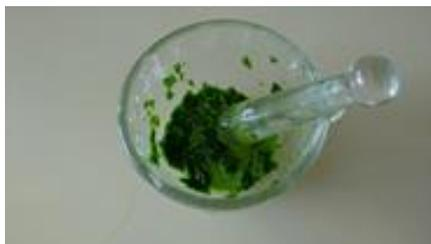
2. Agreguen 30 ml de etanol o alcohol al macerado hasta lograr un líquido de color verde intenso.
