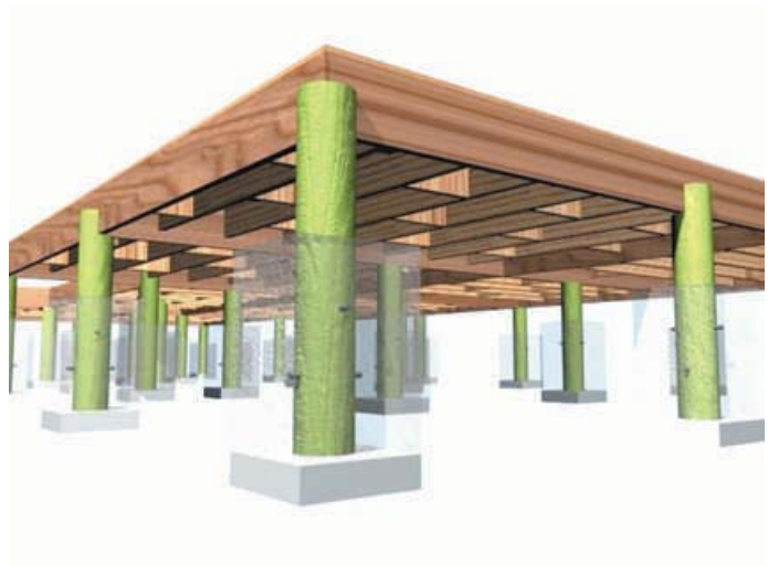
Disposición de los cimientos y pilotes de fundación de acuerdo a plano de cálculo y especificaciones técnicas.
