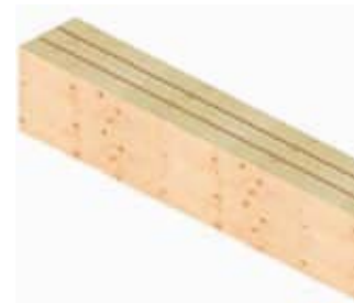
Figura V – 10: Diferentes soluciones para dinteles con dos o tres piezas de madera aserrada de Pino radiata.
