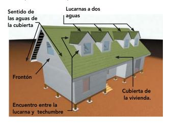
Figura 11-1: Vista en perspectiva de la vivienda con cubierta a dos aguas, donde se aprecia la arquitectura involucrada en la techumbre, que incorpora lucarnas y frontones.
