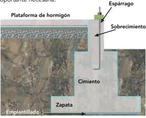
Figura 8 – 8 : Composición de las partes típicas de la fundación superficial, confinada a la plataforma de hormigón, que conforma el piso de la vivienda.
