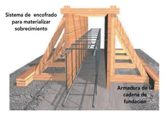
Figura 8 - 31: Control geométrico de la instalación del encofrado del sobrecimiento.
