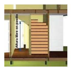
Figura 12 – 18: Se debe verificar la altura libre del pasillo en el sector medio, cuando la estructura de la escalera compromete la totalidad o parte del cielo raso del recinto.
