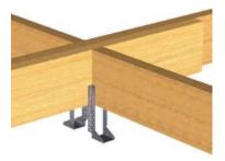
Figura 7-2: Unión de vigas solucionado mediante colgadores metálicos.
