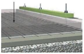
Figura 8 - 56: Colocación de la malla electrosoldada sobre separadores plásticos de 2 cm sobre la barrera de humedad.
