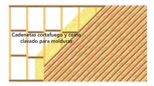
Figura 10 - 23: Revestimiento de molduras dispuesto en forma diagonal, machihembrado o tinglado, que además cumple la función de arriostrar la estructura del muro perimetral o del interior.
