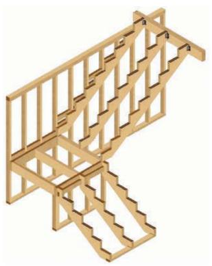
Figura 12 – 31: Esquema general de la estructuración de una escalera en la cual se incluyen los componentes auxiliares en los tabiques para la fijación de las zancas y posteriormente los revestimientos.
