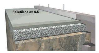
Figura 8 - 55: Instalación de la barrera de humedad, polietileno de e= 0,5 mm.
