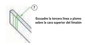
Se marca una línea desde la intersección del eje con la primera línea a escuadra, trazada hasta encontrarse con el vértice de la segunda línea a escuadra.
