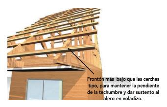
Figura 11-68: Figura que muestra el frontón de una altura menor a las cerchas para generar el alero con las costaneras.
