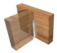
Figura 9 – 49: Conector clavado al friso, fija posteriormente la viga de piso o entrepiso en ambos extremos, igualmente con clavos comunes, fabricado en acero galvanizado de 1,7 mm de espesor.
