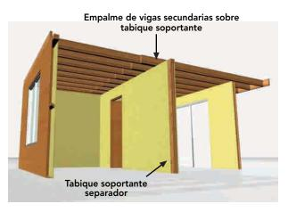
Figura 9 - 35: Vista en perspectiva de la solución del empalme traslapado de las vigas de la plataforma del entrepiso.
