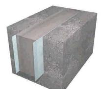
Figura 8 - 26: Cimiento hormigonado de acuerdo a las indicaciones, incorpora un hidrófugo.
