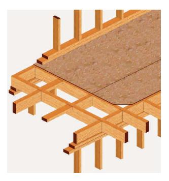
Figura 6 - 12: Elementos horizontales (vigas) apoyados sobre las soleras de amarre de los tabiques del primer piso. Arriostrando el entramado horizontal (plataforma de entrepiso) con tableros contrachapado estructural.
