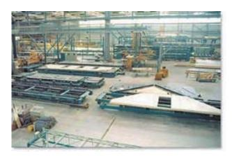
Figura 11-12: Fabricación de cerchas y frontones en planta industrializada.
